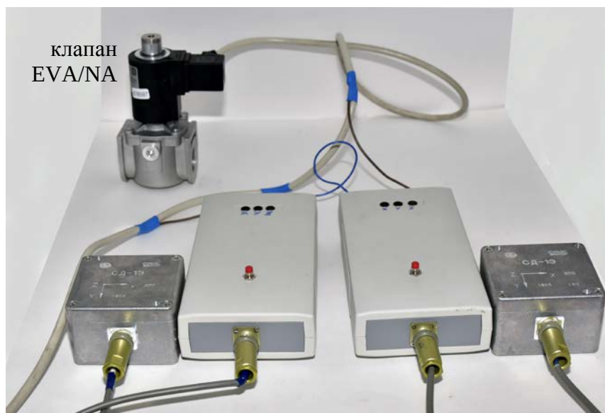
Двухканальная система электромагнитным клапаном EVA/NA.
